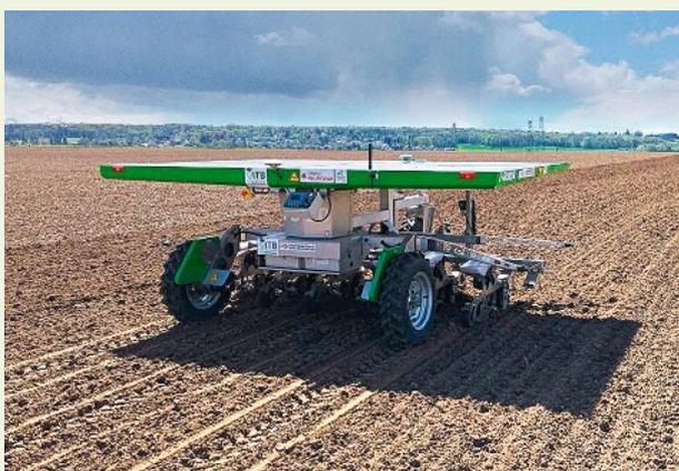
📍 Robot réalisant le binage à l'aveugle.
