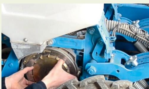
**Éléments distributeurs :** semoir mécanique : vérifier l'usure des disques de sélection. Des alvéoles trop usées sont susceptibles de provoquer des doubles. Vérifier l'état des sélecteurs. Semoir pneumatique : vérifier la planéité des disques de sélection, régler le sélecteur à la taille des graines de betteraves, vérifier l'étanchéité des boîtiers.
