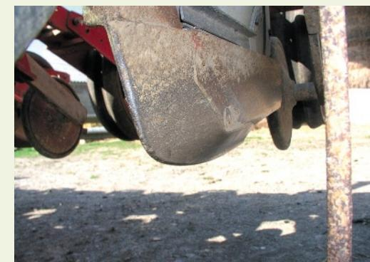
**Socs :** vérifier l'usure des socs en comparant avec un soc neuf. Un fond de sillon arrondi permettra à la graine de rouler dans le sillon, ce qui dégradera la précision du semis. Si les ailes du soc sont usées, de la terre risque de tomber dans le sillon et d'asphyxier la graine dans la terre humide (schéma ci-contre).
