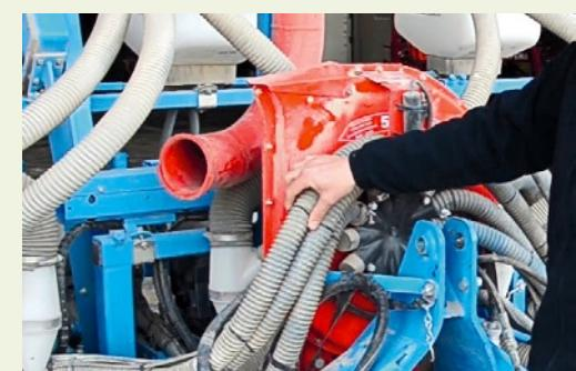
**Aspiration (seoirs pneumatiques) :** vérifier l'usure et la tension des courroies ainsi que le bon état des roulements (pas de bruit suspect en fonctionnement). Vérifier l'étanchéité des gaines du circuit (en particulier aux endroits où elles touchent le métal) et au niveau des raccordements.
