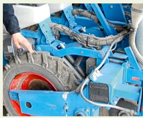
**Châssis :** nettoyer et graisser légèrement les pièces en mouvement. Pneumatiques : contrôler l'usure et la pression des pneumatiques d'entraînement, cela peut modifier l'espacement entre graines.
