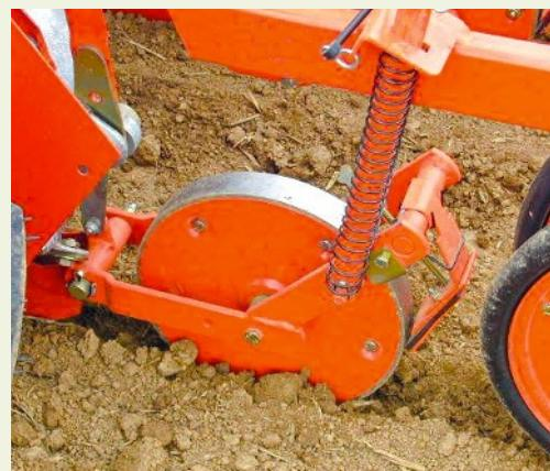
**Roulette de plombage :** vérifier leur bon alignement avec le sillon formé par le soc. Favoriser le contact entre la graine et la terre humide, ne pas tasser la terre au-dessus de la graine.
