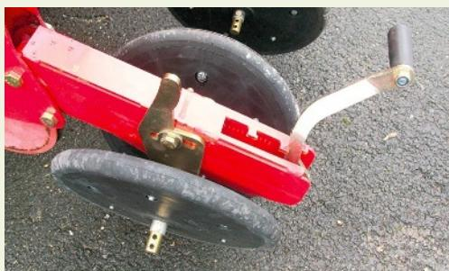
**Roues arrières plombeuses :** vérifier l'écartement des roues de recouvrement en « V », lorsque celui-ci est réglable (sur les semoirs pneumatiques en particulier). Elles doivent être serrées de manière à ce que la graine se trouve dans le prolongement des deux roues pour fermer le sillon. Si ces deux roues restent écartées, elles risquent de remonter la graine et ainsi de modifier la profondeur d'enterrage.
