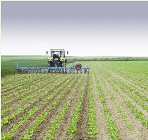
**Le travail mécanique entre les rangs** (binage classique) est complémentaire du désherbage chimique et permet de réduire l'IFT en supprimant le dernier passage de post-émergence. La bineuse est aussi le complément indispensable d'une pulvérisation localisée. Les nouvelles techniques améliorent la vitesse et la précision de travail des bineuses grâce aux nouveaux systèmes de guidage caméra, GPS RTK...
