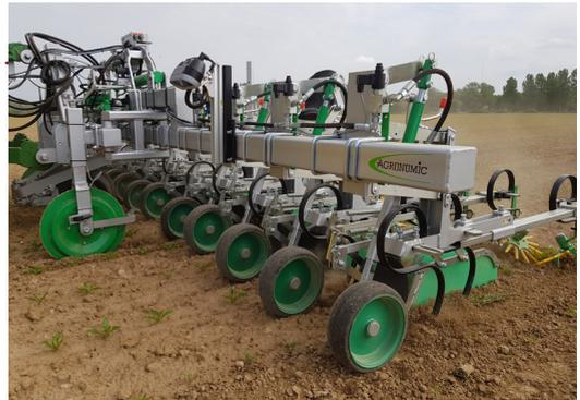
Agronomic adapte la bineuse, par rapport à un besoin, une largeur ou un écartement. Châssis fixe ou repliable hydraulique. Agronomic propose des bineuses poussées, suiveuses ou autoguidées, par trace, caméra ou palpeurs. Bineuses sans entretien : pas de
