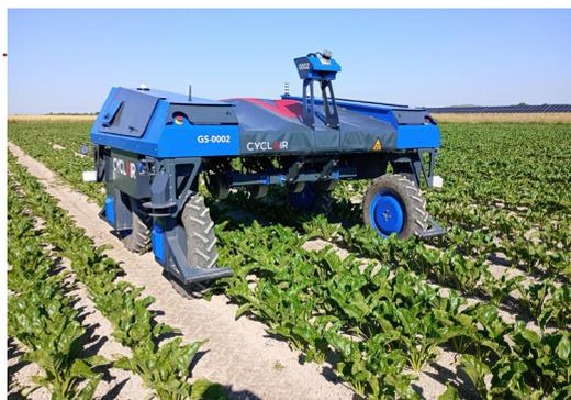
Le robot Cyclair est une machine autonome de désherbage mécanique. Il désherbe dans l'inter-rang et dans l'intra-rang avec des outils de précision.
