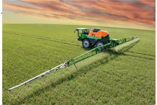
Automoteur Pantera 4504 avec rampe super L3 36 m équipé du système de changement de buse automatique AMASELECT. Présenté en version spot permettant une pulvérisation localisée à partir d'une carte d'application comportant des zones d'exclusion et commandant les buses par tronçons de
