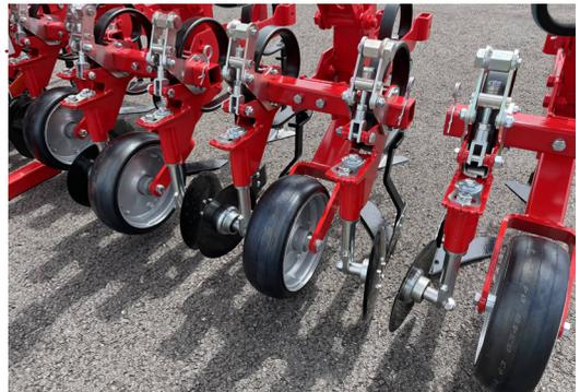
Les bineuses Einböck sont synonymes de technique haut de gamme. Le nouveau réglage rapide "SMART-GRIP" permet d'adapter rapidement et précisément la combinaison innovante de disques de découpes et de lames Lelièvre aux conditions les plus diverses. Les bineuses à doigts ou les
