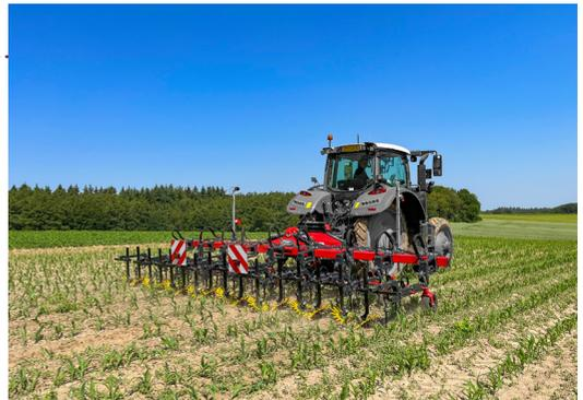
Cet ensemble est composé de deux machines distinctes. La Lynx 2000 est l'interface de guidage dotée de caméra Tillet & Hague. Elle pèse 550 kg et permet une translation de la bineuse jusqu'à 25 cm de chaque côté. L'Onyx 3064F est une bineuse qui se démarque grâce à la rigidité de son élément
