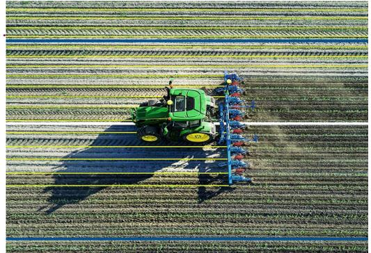
Avec une antenne sur le semoir, les lignes de semis sont cartographiées précisément grâce au RTK. Ces lignes de semis virtuelles serviront de référence pour les passages suivants, prenant en compte toute déviation ayant pu survenir au semis. Les électrodistributeurs du tracteur 6R ou 6M
