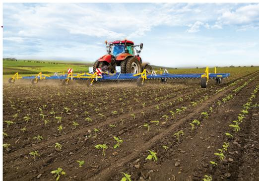
Brevetée depuis 2003 grâce à son système de dents indépendantes qui ne durcissent pas, elle permet d'intervenir très tôt sur toutes les cultures sans les endommager. Un angle d'attaque des dents unique et constant permet d'éviter "l'effet râteau", et a une agressivité suffisante pour écrouter des
