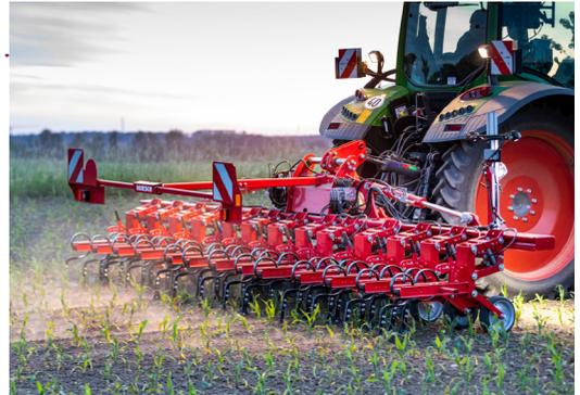
Technologie de binage robuste et précise en largeurs de travail de 6, 9 et 12 m. Inter-rangs de binage de 15 à 80 cm grâce à la fixation des éléments par glissière interne. Guidage par caméra avec un débattement de 450 mm du châssis mobile hydraulique intégré.
