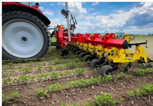
Binage inter-rangs (soc plat et lames Lelièvres) et sur le rang (rotors à lamelles métalliques).
