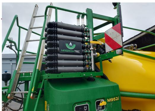
Le kit MagrowTec s'installe sur tous pulvérisateurs à rampe pour apporter de la précision à l'application des produits phytosanitaires. Son action permet de déposer plus de gouttelettes sur la cible tout en diminuant significativement la dérive. Il renforce l'efficacité des traitements en
