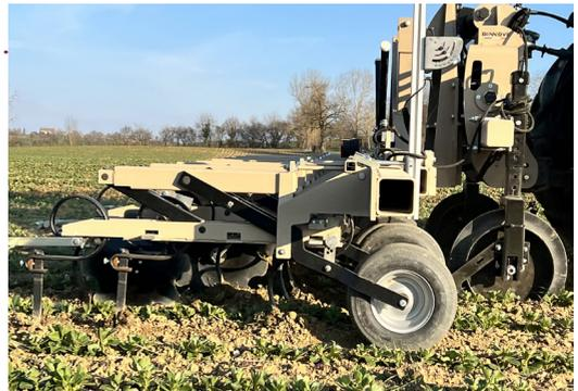
Les bineuses Binнове, fabriquées à la carte en France, se distinguent par leur grand dégagement sous châssis de 75 cm, leur robustesse, un entretien facilité sans graissage nécessaire sur la machine, mais surtout par leur parallélogramme inversé qui est unique sur le marché car breveté. En
