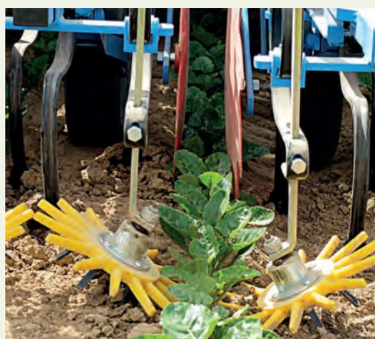
Cet outil se compose d'une bineuse traditionnelle, qui travaille l'inter-rang. Elle peut être complétée par des dispositifs permettant de protéger les plantes à un stade jeune. Afin de travailler sur le rang, cette bineuse est équipée de moulins en caoutchouc.
