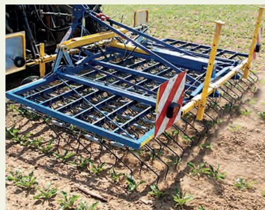
Une herse étrille avec réglage de la pression des dents par ressort se compose de fines dents qui travaillent le sol en surface. Chaque dent est réglée par un ressort individuel.
