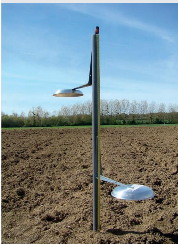
Figure 1. Dispositif sur lequel les badges piégeant l'ammoniac sont positionnés.
