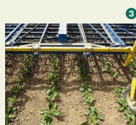
Herse étrille avec réglages des dents par ressort.
