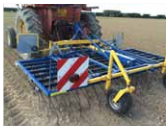
Herse étrille avec réglages des dents par ressort
